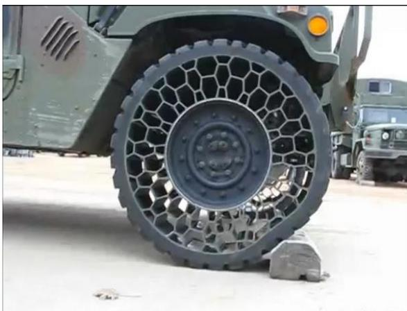
Jante de véhicule en matériaux déformable façonnée en nid d'abeille
